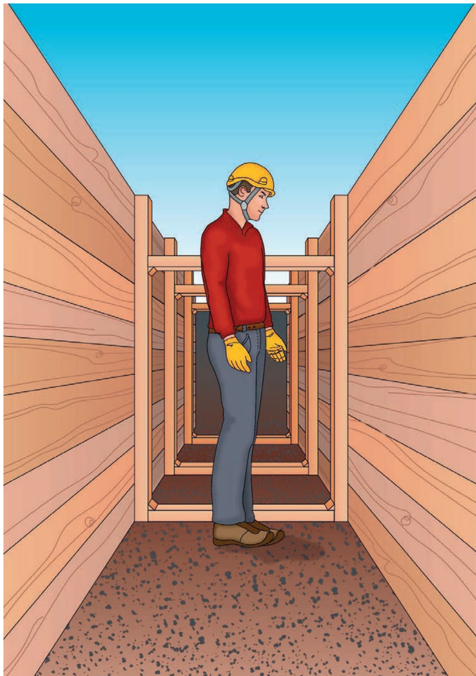
Figura 1 - Sistema realizzato totalmente in legno
